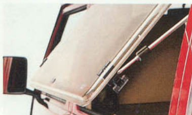
Unterstützt die Frischluftventilation: das ausstellbare Acrylglass-Isolierfenster.
